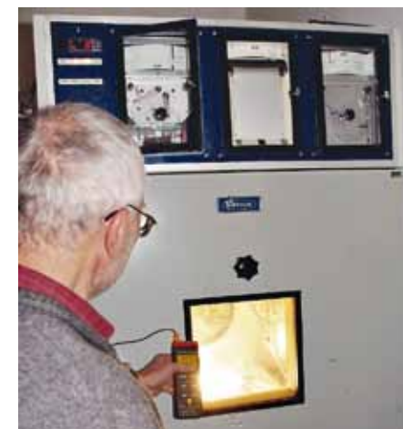
Funktionstest im Klimaschrank
