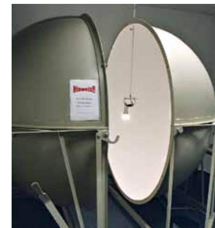
Lumenmessung in der Ulbrichtkugel
